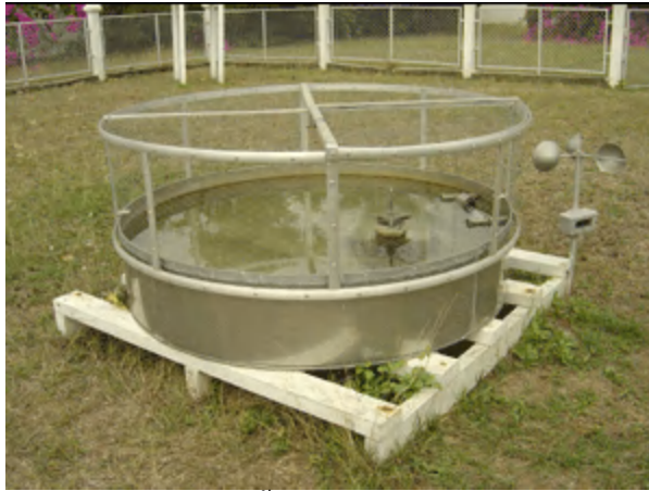
รูปที่ 2 เครื่องมือวัดน้ำระเหยขนาดใหญ่ (American Class A pan)
